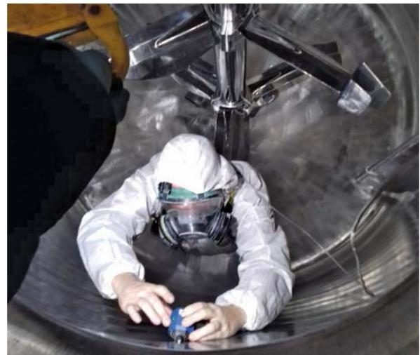
El arenado, básicamente con microesfera de vidrio, se utiliza cuando se quiere obtener un acabado estéticamente uniforme, aplicando siempre un pasivado posterior para asegurar la descontaminación y un acabado óptimo.
