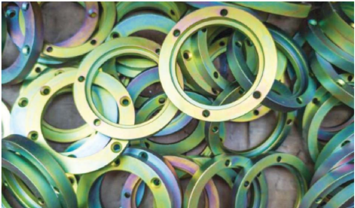
Piezas de acero cincadas con un tratamiento a base de sales de cromo
